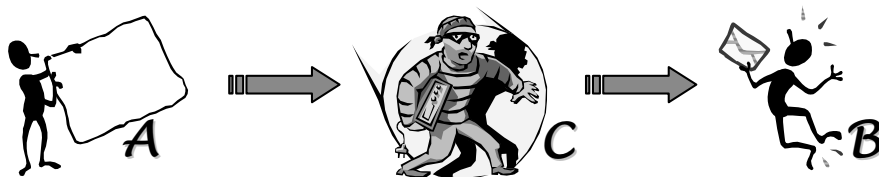
Figura 1.13. Ataque man-in-the-middle: el intruso C intercepta la información que el usuario A envía a través de la red, reenviándola posteriormente al usuario B
