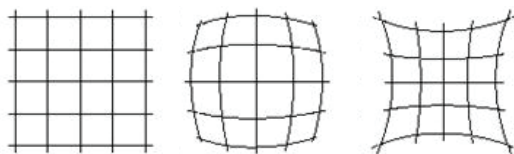
Figura 2.13: Imagen ideal y con distorsiones de tipo barril y cojín
