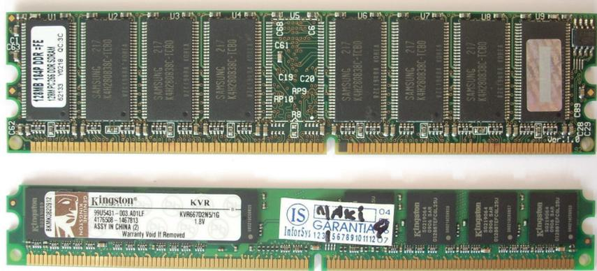
*Figura 1.4. Módulo DIMM de memoria DDR y DDR-2*
