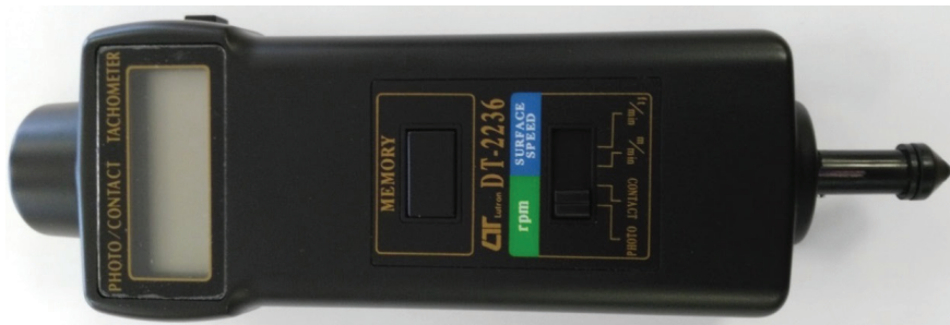
Figura 1.9. Tacómetro para medir la velocidad de rotación de ejes de motor
