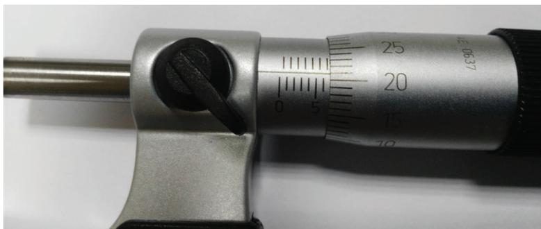
*Figura 1.17. Micrómetro de tambor de 50 divisiones. Resolución 0,01 mm*
