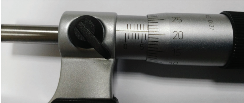
Figura 1.17. Micrómetro de tambor de 50 divisiones. Resolución 0,01 mm
