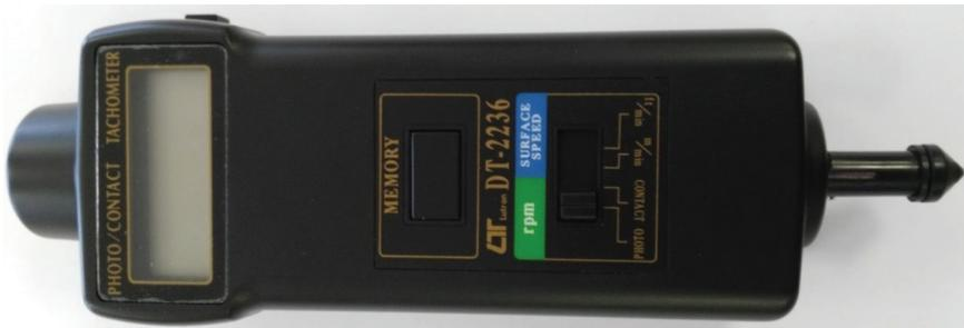
*Figura 1.9. Tacómetro para medir la velocidad de rotación de ejes de motor*
