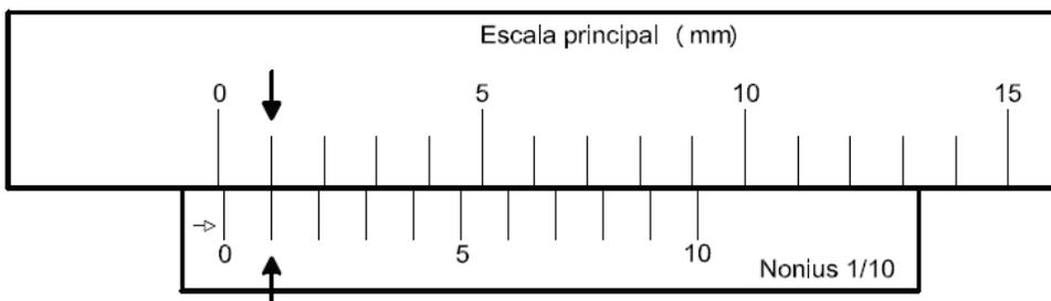
*Figura 1.12. Desplazamiento del nonius 0,1 mm a la derecha*
