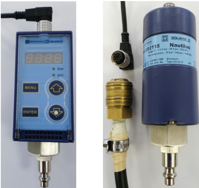
Figura 1.7. Transductor de presión de 0 a 2,5 bar y salida de 0 a 10 voltios, con indicación en display en bar o en psi
