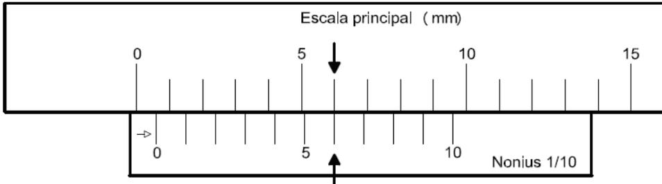
Figura 1.13. Desplazamiento del nonius  $0,1 * 6 = 0,6$  mm a la derecha
