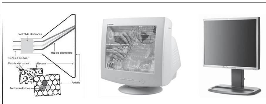
Figura 1.30. Tubo de rayos catódicos y píxeles de color. Monitor de tubo y LCD.
