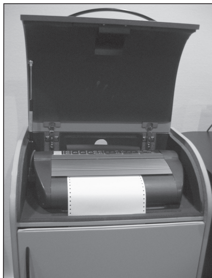
Figura 1.37. Impresora Braille. El modelo Juliet imprime 40 cps.
