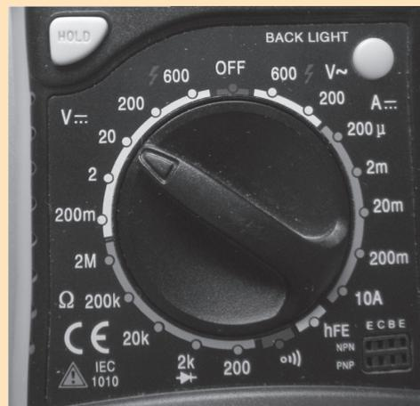
*Figura 1.37. Detalle de la configuración del rotor conmutativo*
