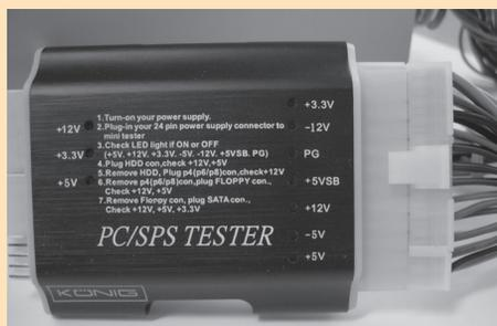
*Figura 1.38. Tester de fuentes de alimentación*
