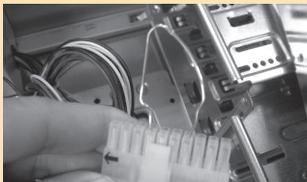
*Figura 1.35. Puenteo del conector macho ATX*
