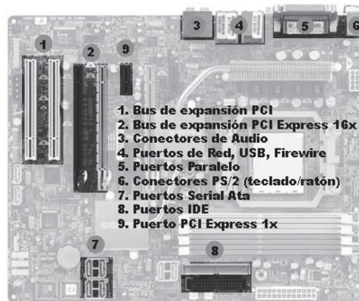
Figura 1.18. Buses y ranuras de expansión de una placa base
