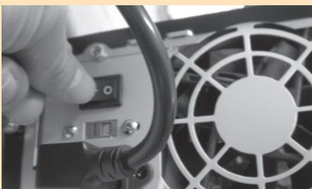
*Figura 1.36. Encendido de la fuente de alimentación*
