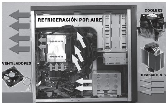
Figura 1.8. Descripción de un sistema de refrigeración por aire
