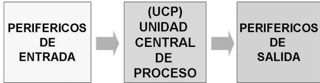
*Figura 1.5. Esquema de bloques de un ordenador*
