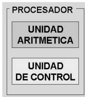
*Figura 1.7. Esquema básico de un procesador*
