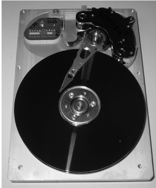
*Figura 1.8. Imagen interna de un disco duro*
