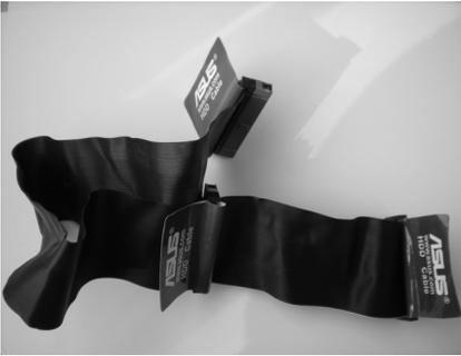
**Figura 1.15.** Cable bus IDE. (Utilizado para conectar placa base y lector óptico o HD)
