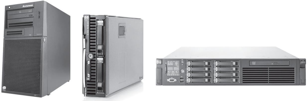
*Figura 1.4. Tipos de servidores: Torre, Blade y Rack*
