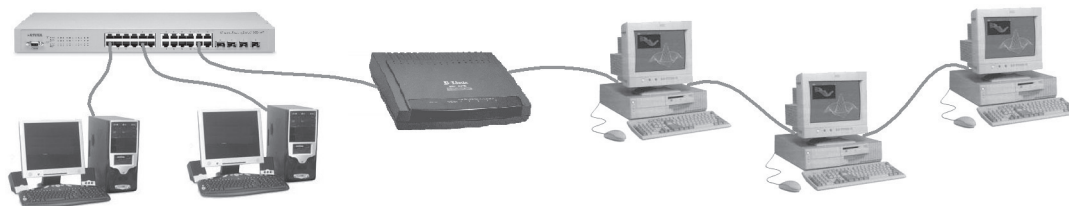
Figura 1.40. Esquema básico de interconexión de un puente
