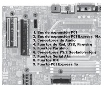
**Figura 1.9.** Conectores y buses de la placa base
