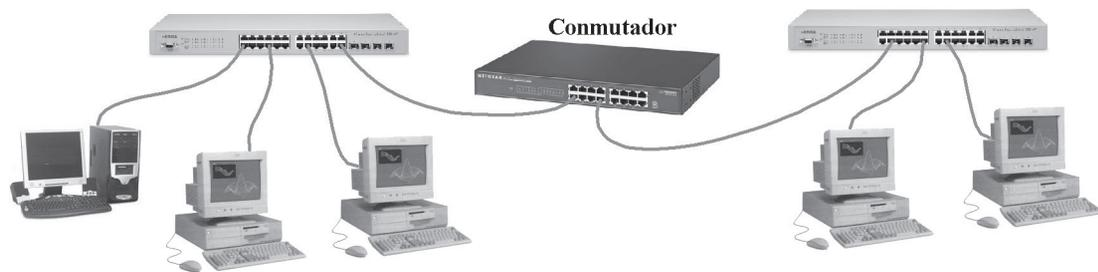
*Figura 1.39. Segmentación de una LAN utilizando un conmutador*
