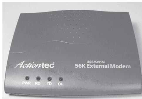
*Figura 1.34. Módem RTC externo*
