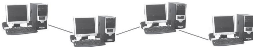
Figura 1.8. Red con topología en bus.
