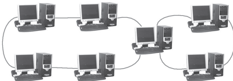
Figura 1.11. Red con topología en intersección de anillo.
