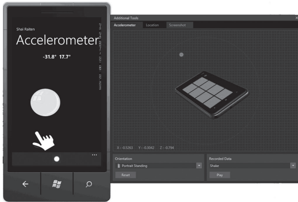
Figura 1.35. Emulador del comportamiento de un acelerómetro (fuente: http://blogs.microsoft.co.il/blogs/shair/archive/2012/01/28/accelerometer-sensor-for-windows-phone-7.aspx )
