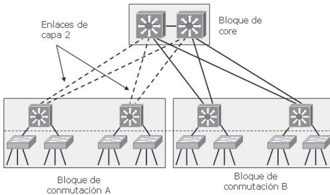
La redundancia de nivel 3 entre distribución y *core* no podrá ser posible debido a que no existen protocolos de enrutamiento para realizar el balanceo de tráfico, así que la mala utilización de los *uplinks* por la extensión de las VLAN se verá drásticamente empeorada por la imposibilidad de balancear el tráfico con STP estándar.
