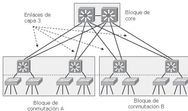
La ventaja fundamental del bloque de *core* funcionando como *dual core* es que es posible utilizar *uplinks* de cada uno de los bloques de conmutación de forma paralela y balanceada. Esto es posible gracias a los protocolos de enrutamiento de capa 3, que permiten balancear el tráfico de esta manera, gracias a que los *switches* de distribución de los bloques de conmutación y los *switches* del *core* son *switches* de capa 3.
