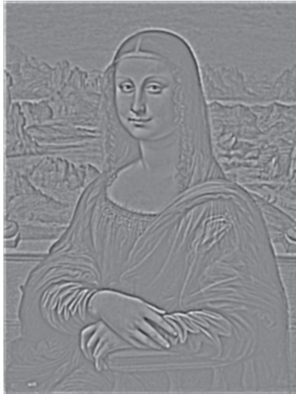
Figura 1.13: Resultado de aplicar una laplaciana de gaussiana de \sigma = 3 .
