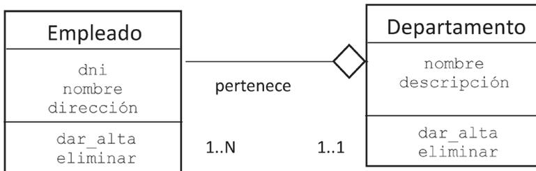
Ilustración 56.4. Ejemplo de agregación en UML
