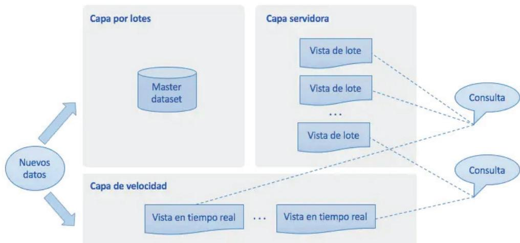
Figura 2.5. Esquema base de una arquitectura lambda
