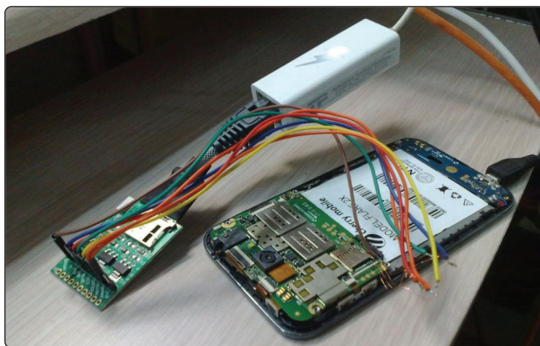
Ilustración 8. Ejemplo de JTAG para la obtención de datos de un dispositivo móvil. Fuente: Digital Forensics Corp.
