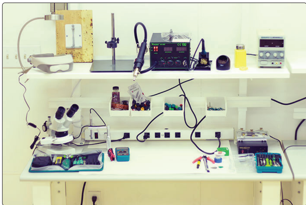
Ilustración 12. Ejemplo de banco de trabajo para realizar JTAG, chip-off e ISP. Fuente: TeelTechnologies.
