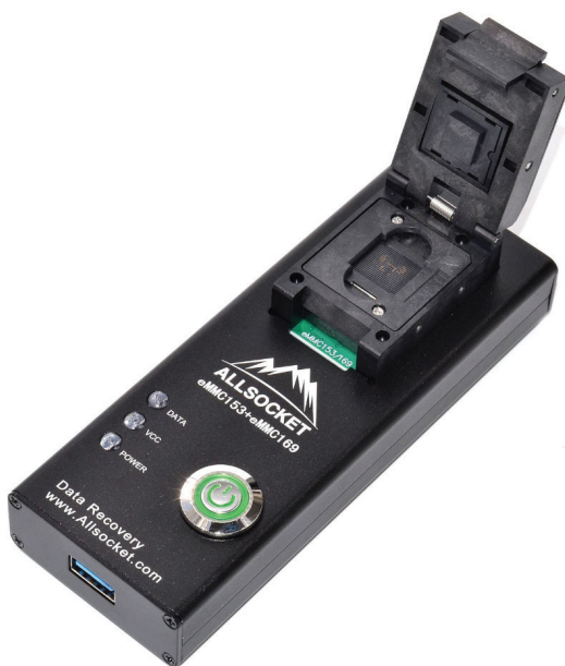
Ilustración 11. Ejemplo de lector de chips eMMC y eMCP para técnicas chip-off. Fuente: Amazon.
