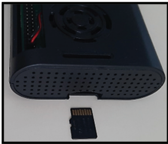
Figura 3.6. Inserción de la tarjeta microSD sobre la Raspberry Pi 4
