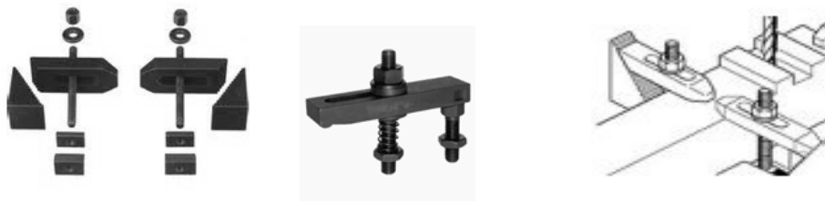
Figura 2.49. Juegos de bridas. Sujeción mediante bridas
