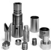
Figura 2.10. Piezas cilíndricas y de revolución
