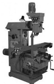
Figura 2.29. Movimientos principales de la fresadora
