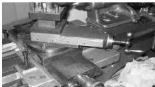
Figura 2.21. Carro orientable desplazado 45°
