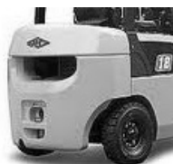
Figura 2.4. Parte trasera con interior contrapesado
