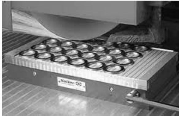
Figura 2.52. Ejemplo de sujeción en un plato magnético
