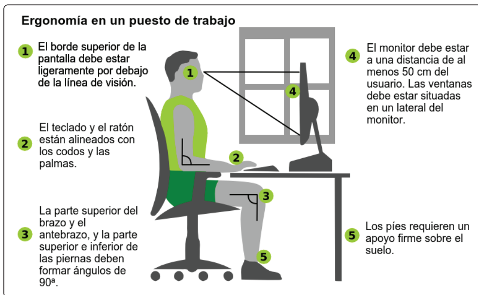
Figura 1.1. Postura ergonómica enfrente del puesto de trabajo. Modificado sobre el original de Marcel Kollmar ( commons.wikimedia.org/wiki/File:Ergonomic_workstation.png )
