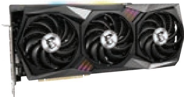
**Figura 2.11.** Las tarjetas VGA más potentes del mercado corren con una memoria GDDR6X a 21 Gbps y con capacidades que rondan los 24 GB. Además, combinan tecnologías como el trazado de rayos o RDNA, que mejoran notoriamente la ejecución de videojuegos.
