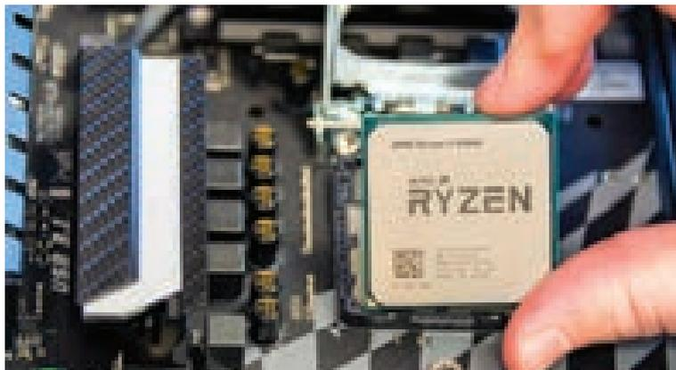
**Figura 2.2.** APU (Accelerated Processing Unit) es la gran innovación de AMD de los últimos años. La función con Radeon ha dado al mercado una CPU más una GPU en una misma cápsula, con excelente rendimiento y buenos beneficios.
