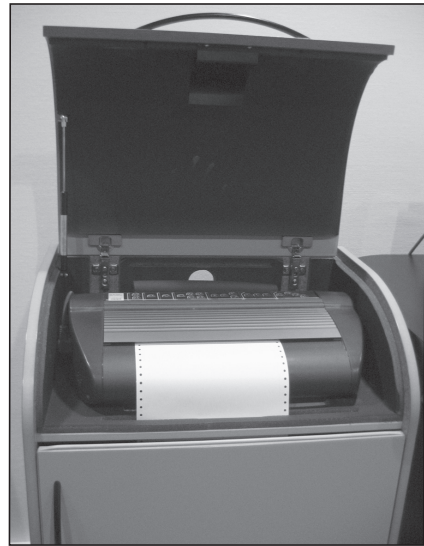
Figura 1.37. Impresora Braille. El modelo Juliet imprime 40 cps.
